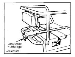
Le véhicule comporte un attelage à languette sur le pare-chocs arrière. Un crochet peut être installé sur l'attelage actuel. Communiquer avec le concessionnaire autorisé pour de plus amples informations
